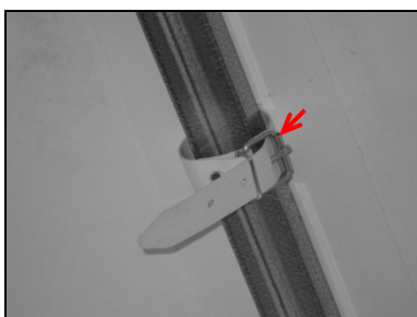
Обтягащ ремък на напречна дъга на покривало
